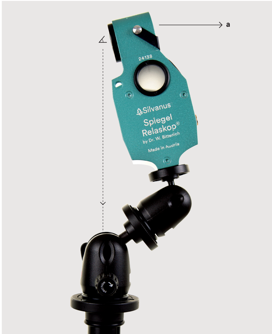
Abb. 4: Das Spiegel-Relaskop® auf Dreibeinstativ mit feststellbaren Kugelgelenken a = Distanz zwischen Auge und Mittelpunkt des zu messenden Stammquerschnittes
