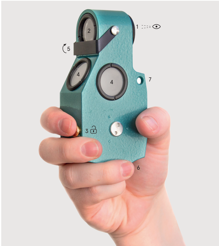
Abb. 3: Das Spiegel-Relaskop® und seine Handhabung
