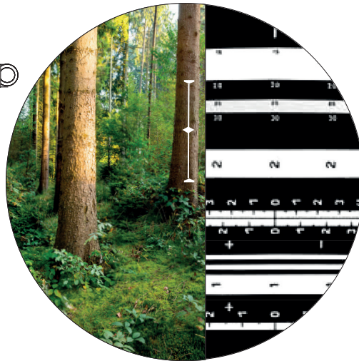
Abb. 10: Metrisch Standard bei der Distanzmessung mit 2 m-Vertikalbasis: Illustration des Skalenbilds, das beim Blick durch das Spiegel-Relaskop® erscheint, wenn die Distanz zum Baumschaft genau 20 m beträgt. Analog können die Distanzen 15, 25 und 30 m aufgesucht werden.
